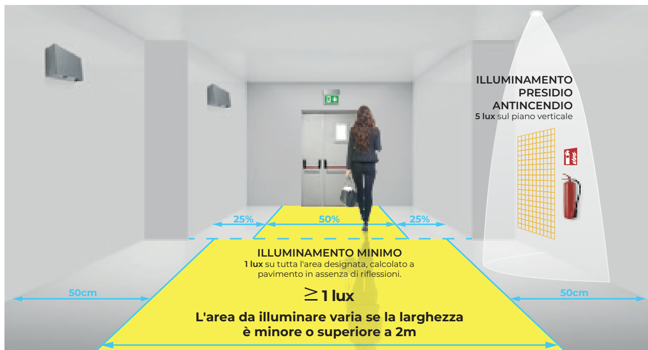
Fig. 2 – Illuminazione della via di esodo
