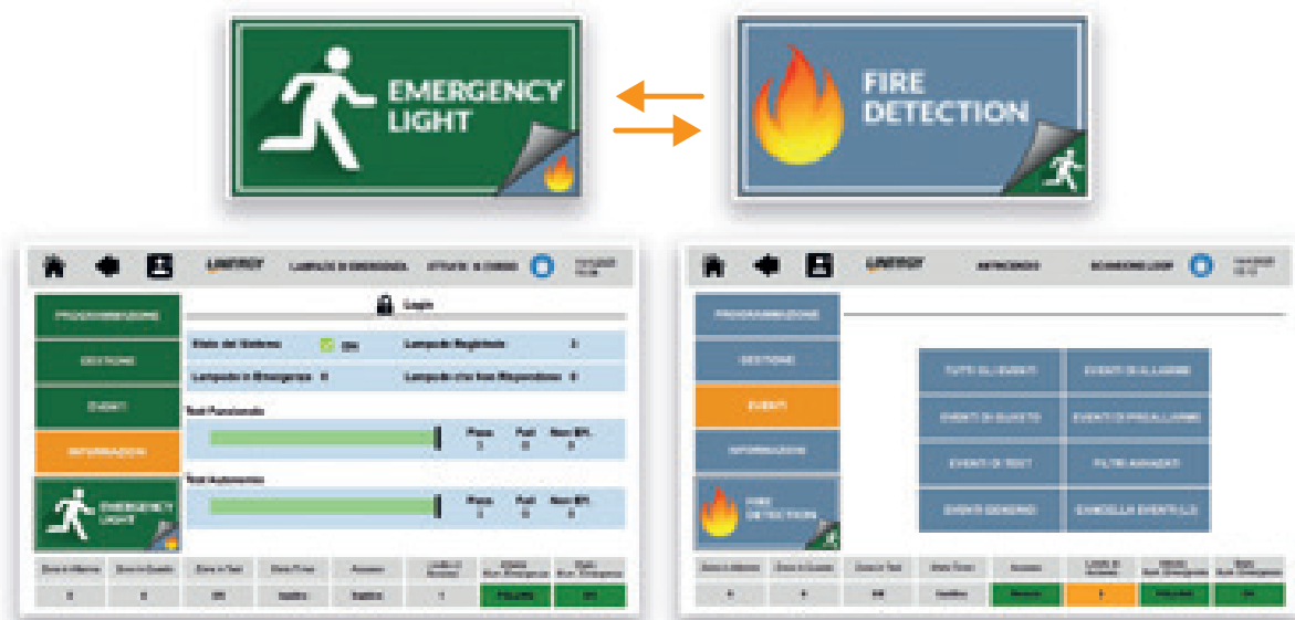
Fig. 4 – Pannello di controllo - sistema integrato per il controllo dell'illuminazione di emergenza e rivelazione incendi
